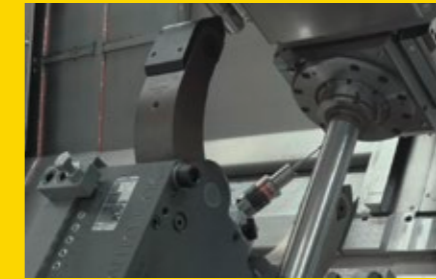
Dies geschieht mit unterschiedlichen B-Achsenwinkeln und unterschiedlichen Spannzuständen (Frässpindel gespannt/unge-spannt, B-Achse gespannt/unge-spannt, ...)
