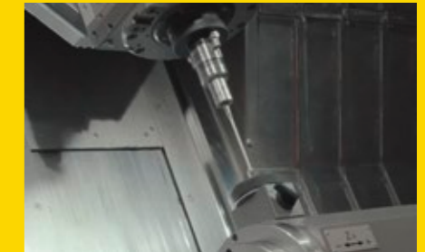
Anschließend wird die Wiederholgenauigkeit des Messtasters mithilfe des Kalibrierrings überprüft. Der Werkstückmesstaster wird kalibriert und auf Wiederholgenauigkeit überprüft.
