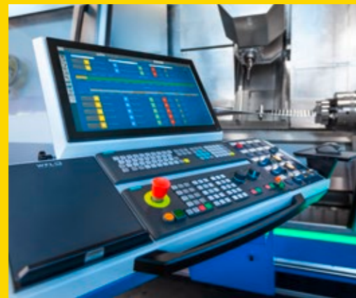
In der Dashboard-Übersicht werden Daten wie Maschinenzustand, Performance, Betriebsarten und Overridestellungen im zeitlichen Verlauf sowie Betriebsstunden, Kanalstatus, aktives NC-Programm uvm. angezeigt.
