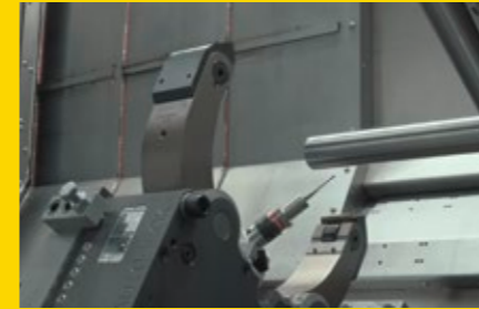
Der Rundlauf und die Ausrichtung der Frässpindel werden mit einem Prüfdorn in der Dreh-Bohr-Fräseinheit gemessen.
