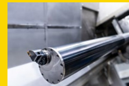
Mit der Systembohrstange können Standardwerkzeuge zusammen mit der Prismenwerkzeugschnittstelle verwendet werden.
