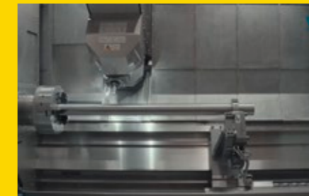
Nach dem Einspannen eines langen Werkstücks in das Spannfutter und den Reitstock wird die Position des Reitstocks im Verhältnis zur Hauptspindel automatisch gemessen (auch für Gegenspindel verfügbar).
